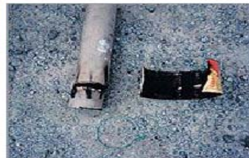
排気筒の外れを缶で塞いだ例
