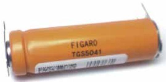
電気化学式 CO センサ(TGS5041)の外観
