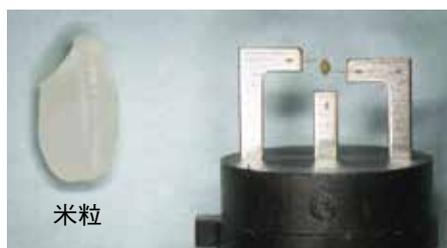
メタン・CO 複合型ガスセンサ(SB-95)の構造
